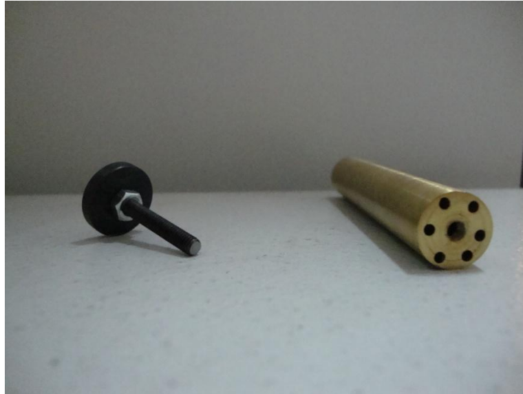
Figura 5.1 Foto dell'ugello progettato, le componenti e l'assemblaggio finale.
