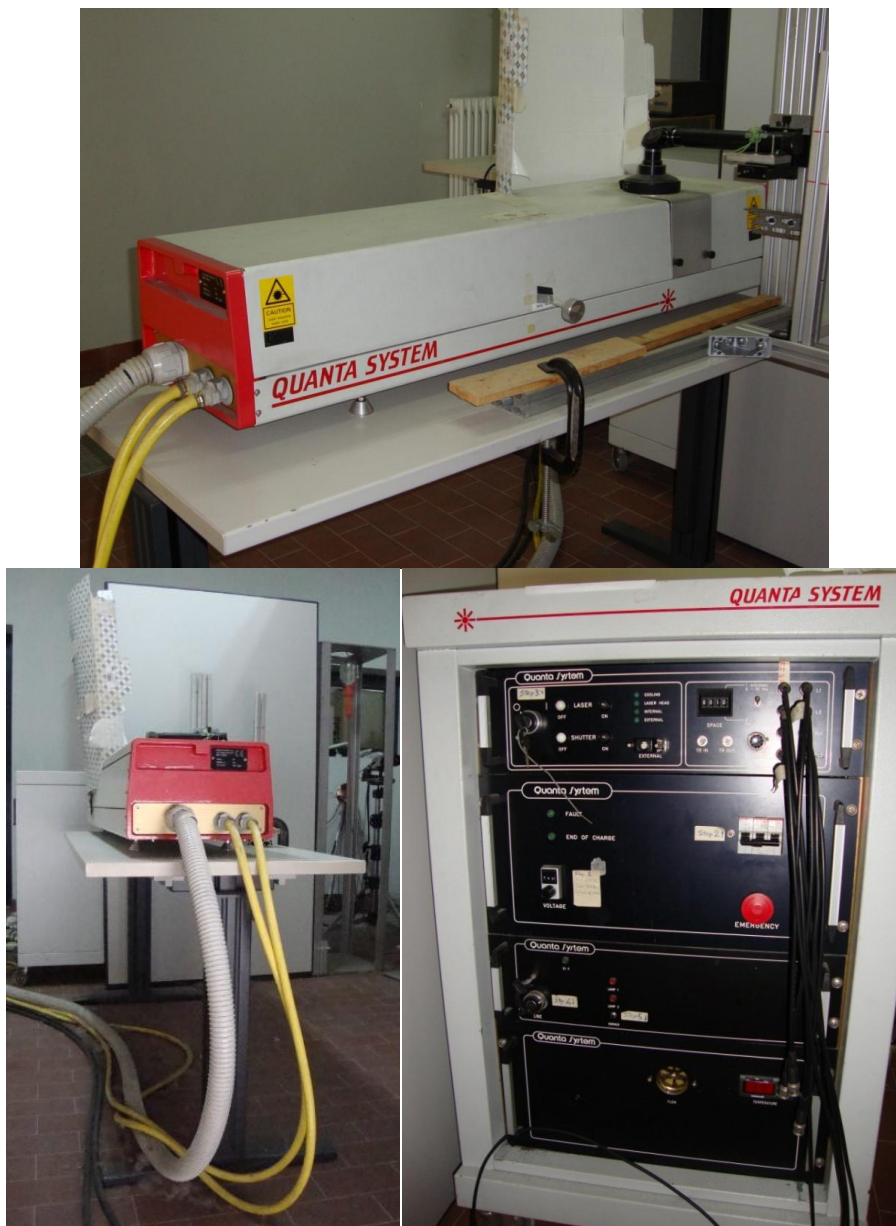
Figura 4.14 Sistema laser utilizzato per illuminare il campo di indagine, con relativo sistema di controllo
