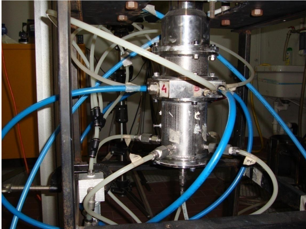
Figura 3.3 Foto del bruciatore a swirl e del sistema di alimentazione di aria
