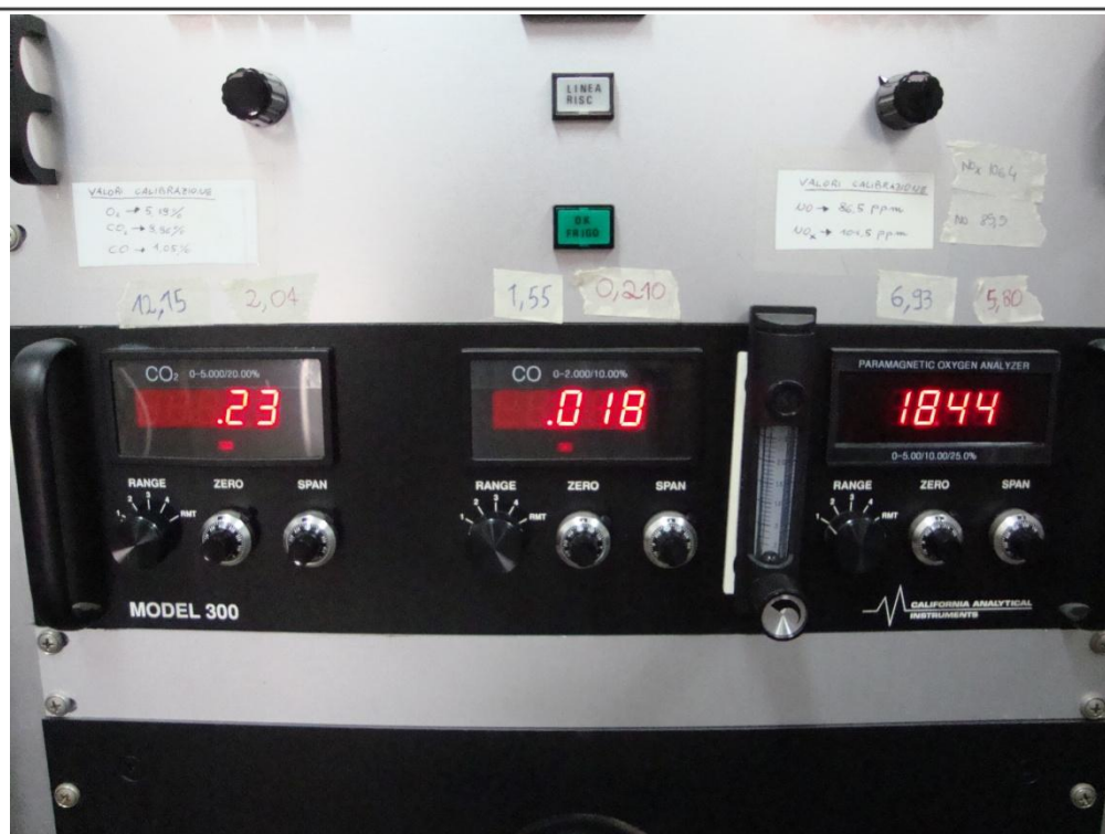
Figura 4.7 Pannello frontale dell'analizzatore di CO_2, O_2 e CO [21] e foto
