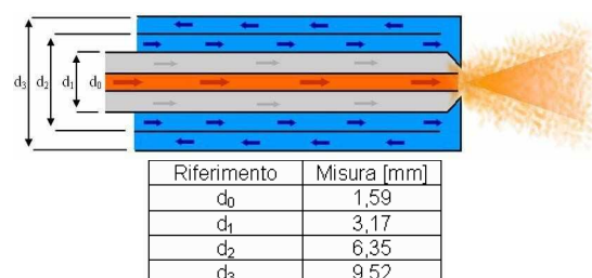
Figura 6: schema del dispositivo di atomizzazione del combustibile liquido. Si notano il flusso dell'acqua di raffreddamento (in azzurro), il flusso di azoto (in grigio) e il flusso di combustibile liquido (in arancione). Sono inoltre riportate le dimensioni caratteristiche del dispositivo.
