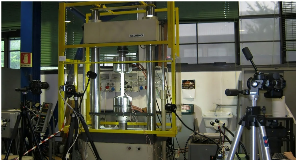
Figura 3.21. Fotocamere e illuminazione in opera durante le prove.
