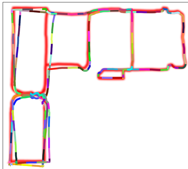
Figura 9.16: Traiettorie della migliore sessione di SLAM con odometria per il dataset di Bicocca. La traiettoria color rosso in sottofondo è la ground truth. La traiettoria stimata ha diversi colori a indicare le diverse sottomappe ottenute con lo SLAM condizionalmente indipendente.
