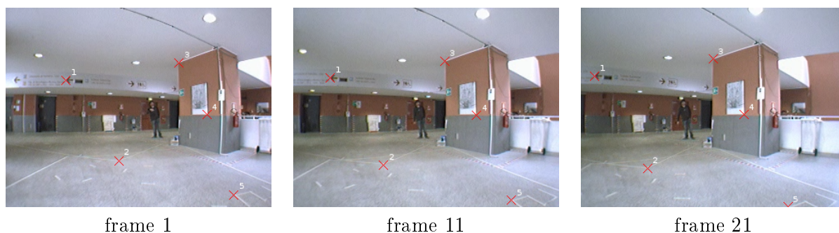
Figura 3.1: Il processo di tracking: i punti caratteristici marcati con una croce rossa e numerati vengono seguiti per una sequenza di 20 frame, dei quali ne sono mostrati tre.
