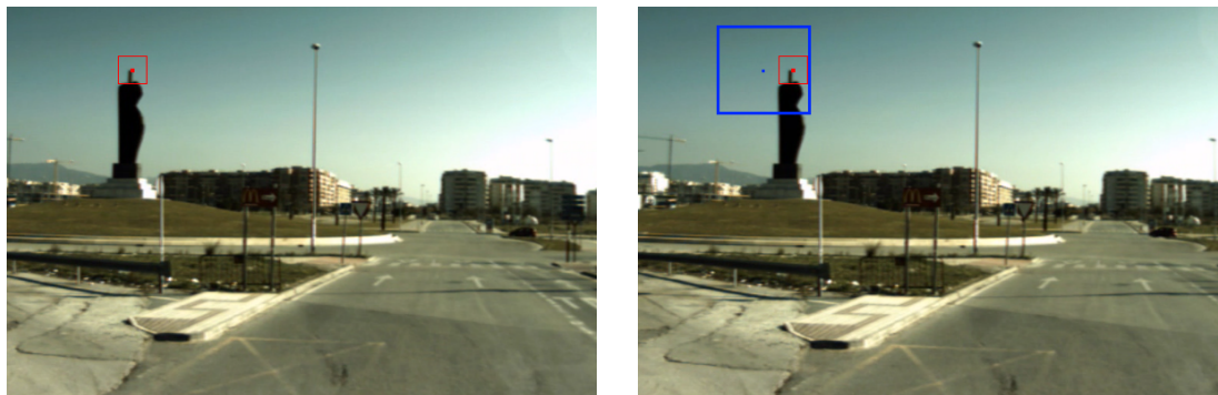
Figura 3.2: Patch tracking: Nell'immagine di sinistra è mostrato un punto caratteristico (punto rosso) e la sua patch delimitata dal quadrato rosso. L'immagine sulla destra è il frame successivo: il quadrato blu identifica l'area di ricerca centrata nella posizione che assumeva il punto caratteristico nella prima immagine, il punto e quadrato rosso identificano il miglior match fra le patch dei punti nell'area di ricerca e la patch del punto caratteristico
