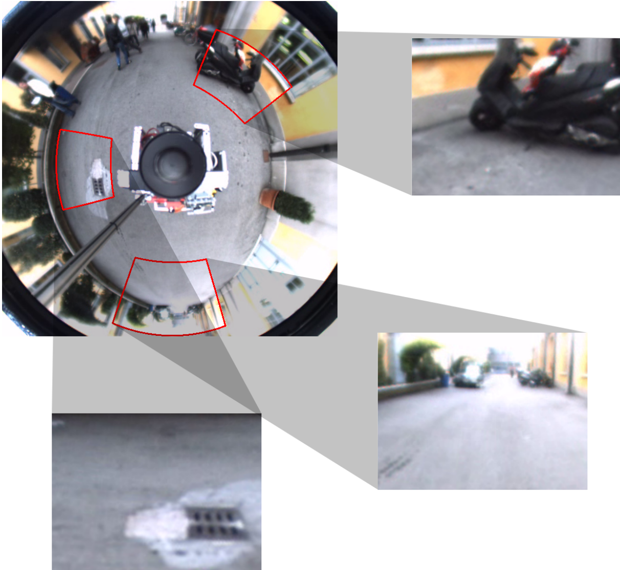
Figura 7.8: Ricostruzione di immagini prospettiche da un'immagine omnidirezionale
