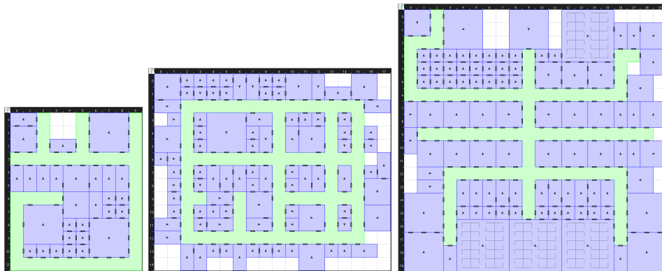
Figura 5.1: Mappe utilizzate nei test sperimentali. Nell'ordine le mappe per 2, 5 e 8 robot. Tutte e tre le mappe simulano complessi di uffici. In verde sono rappresentati i corridoi, in azzurro le singole stanze. Sugli assi di ogni figura sono rappresentate le dimensioni della mappa nell'unità di misura adottata dal simulatore e corrispondente a 3 metri. In metri, le dimensioni delle mappe sono, rispettivamente: 27m x 33m, 51m x 42m e 57m x 57m.
