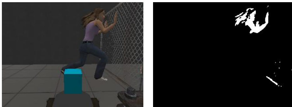
Figura 4.5: Vittima rilevata dal modulo di victim detection di PoAReT. A sinistra l'immagine catturata dalla telecamera. A destra il risultato della fase di skin detection dove le zone bianche sono state classificate come pelle.
