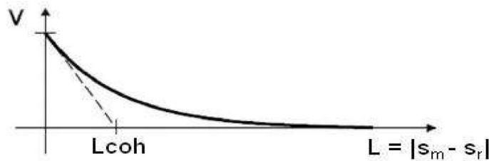
Figura 1.13: Andamento della visibilità V in funzione della differenza di lunghezza dei bracci.
