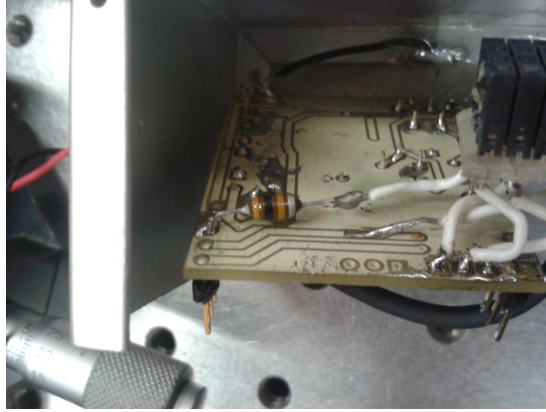
Figura 3.7: Induttanza per evitare giri di massa.
