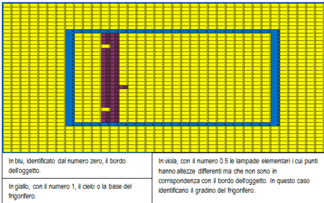
Figura 5.33: foglio "bol". Risultato dell'identificazione del bordo dell'oggetto. La funzione "concentricita" si basa su questa matrice.
