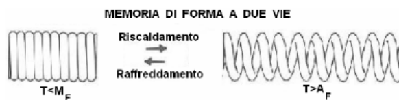
Figura 1.21: Memoria di forma a due vie in funzione della temperatura
