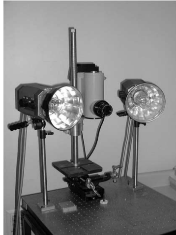
Figura 2.1: Apparato per termografie dell'Université Laval
