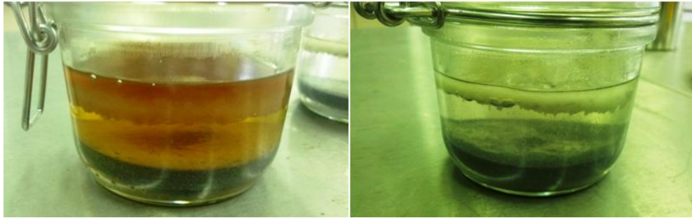
Figura 5.3 - Pannello e breaker dopo 24h a 80°C. PAG a sinistra, PAF a destra
