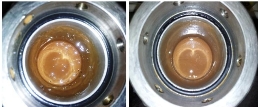
Figura 5.19 - Pannelli del DIF commerciale. A sinistra quello trattato con la microemulsione, a destra quello trattato con il GLUCOPON™
