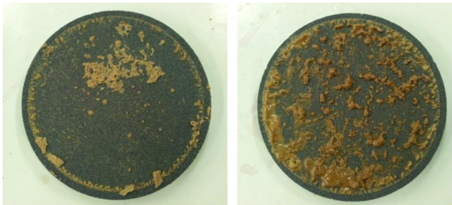
Figura 5.21 - Setti dopo flussaggio finale con acqua. A sinistra quello trattato con la microemulsione, a destra quello trattato con il GLUCOPON™
