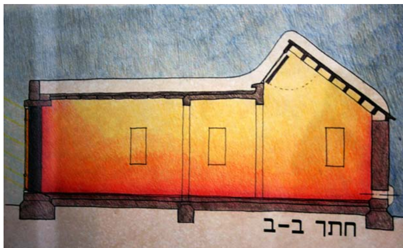
Comportamento termico dell'edificio, ventilazione naturale del pavimento e particolare delle bocchette di ventilazione a pavimento - fotografia del disegno originale, CDAUP
