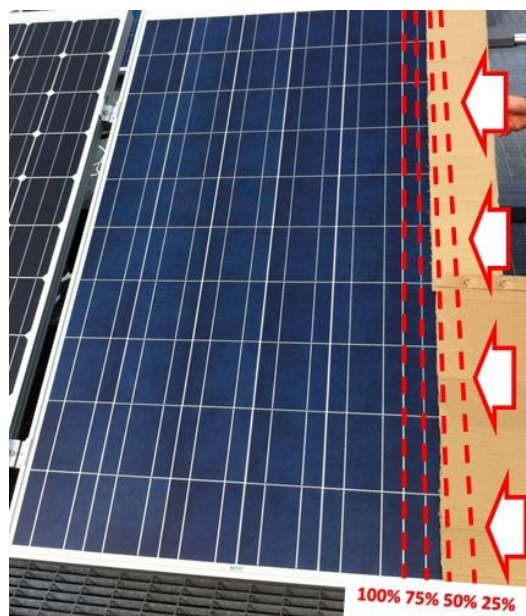
Figura 4.14-Modalità di ombreggiamento per tutta la lunghezza del modulo.
