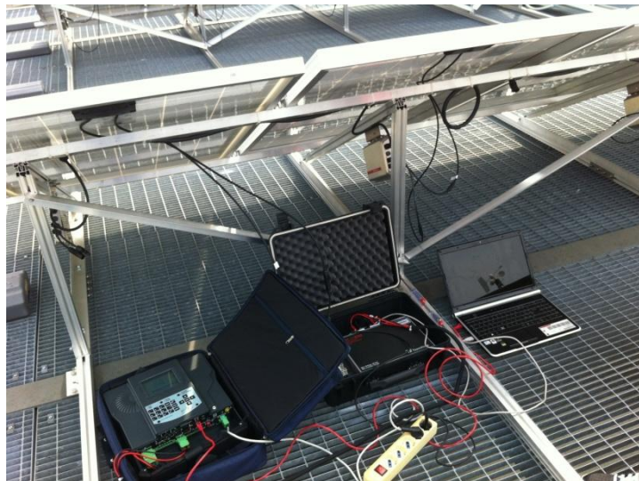
Figura 4.3-Strumentazione per il rilievo delle curve caratteristiche dei moduli presente nel SolarTech Lab
