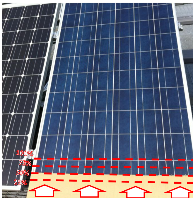
Figura 4.15-Modalità di ombreggiamento orizzontale dei moduli.
