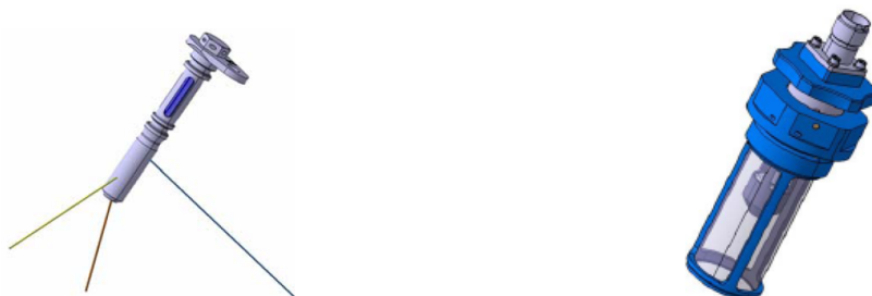
Figura 1.12 – Ugello di lubrificazione e Chip Detector
