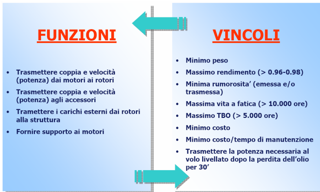
Figura 1.5 – Funzioni e vincoli nella progettazione di una trasmissione elicotteristica
