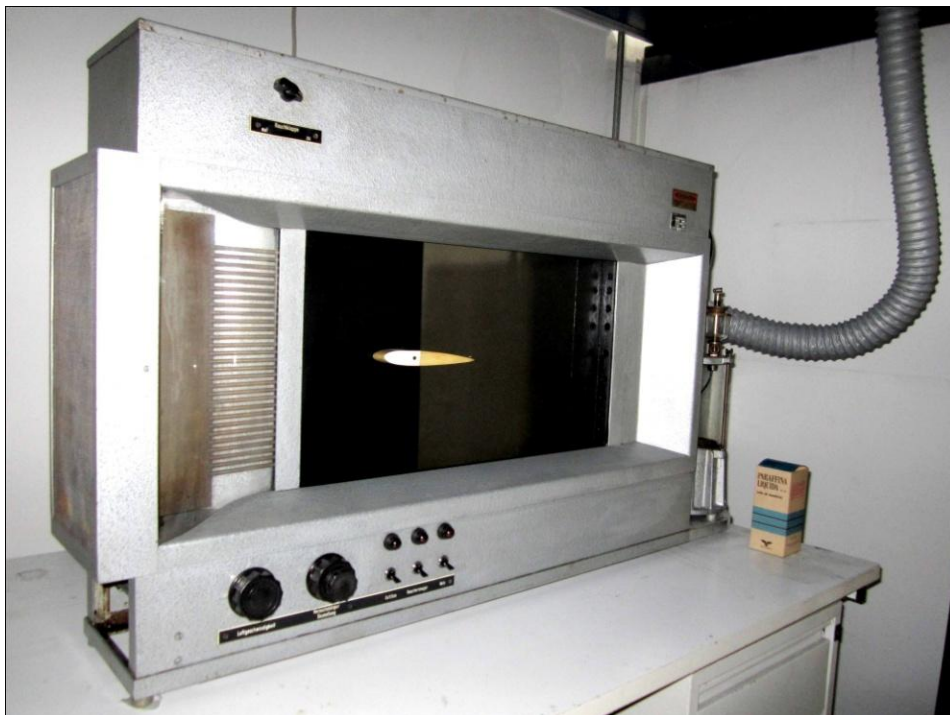
Figura 3.10 Galleria del vento
