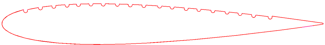
Figura 3.6 NACA 0013 con scasso sul dorso, provvisto di canalini di scolo per la colla
