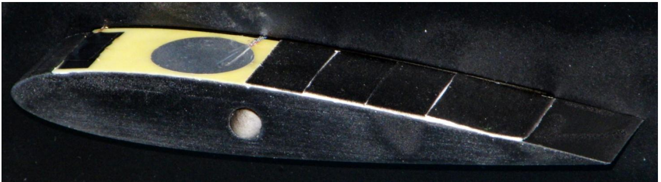
Figura 3.36 Attuatore montato sopra il profilo. Materiale riempitivo per non formare dei gradini sulla superficie
