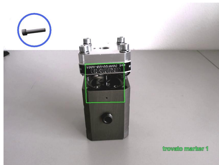
Figura 5.30 – Il coperchio, correttamente posizionato, deve essere avvitato.
