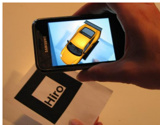
Figura 2.10 – Esempio di applicazione di Realtà aumentata con marker fiduciali (ARToolkit).
