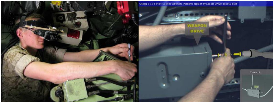
Figura 3.11 – Progetto ARMAR. Esecuzione di un'operazione di manutenzione.
