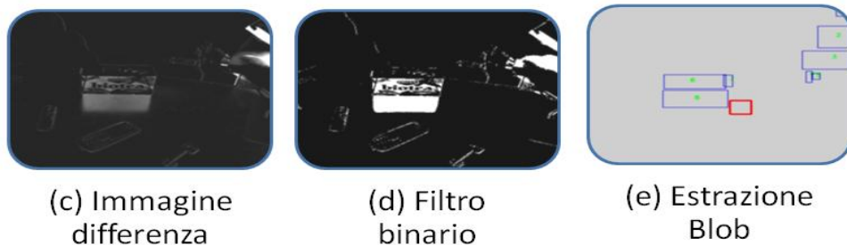
Figura 4.16 – Esecuzione dell' algoritmo di blob detection implementato nelle operazioni BlobPG e BlobED .
