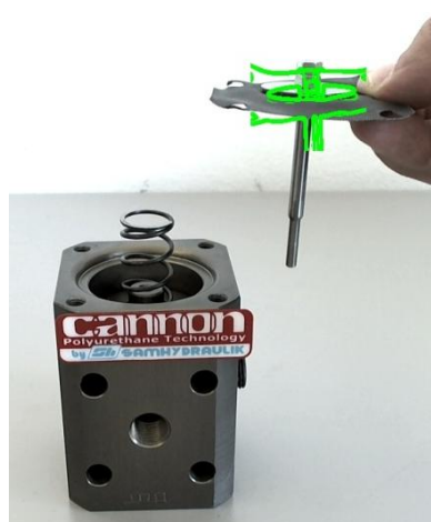
Figura 5.27 – Sequenza del passo operativo corrente: lo spintore deve essere inserito correttamente nella propria sede.
