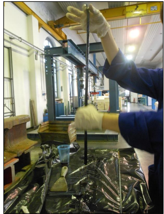
Figure 7.10 e 7.11 – Impregnazione della corda in fibra di carbonio con resina bicomponente
