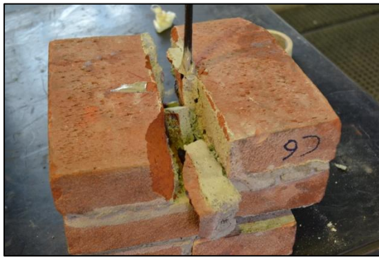
Figura 6.20 – Rottura di tipo D del campione MC6. Crisi in corrispondenza del giunto di malta dell'ultimo corso di mattoni
