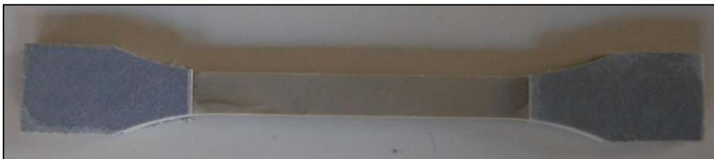
Figura 4.15 – Immagine dei campioni realizzati con resina Sika® Anchorfix®-3+
