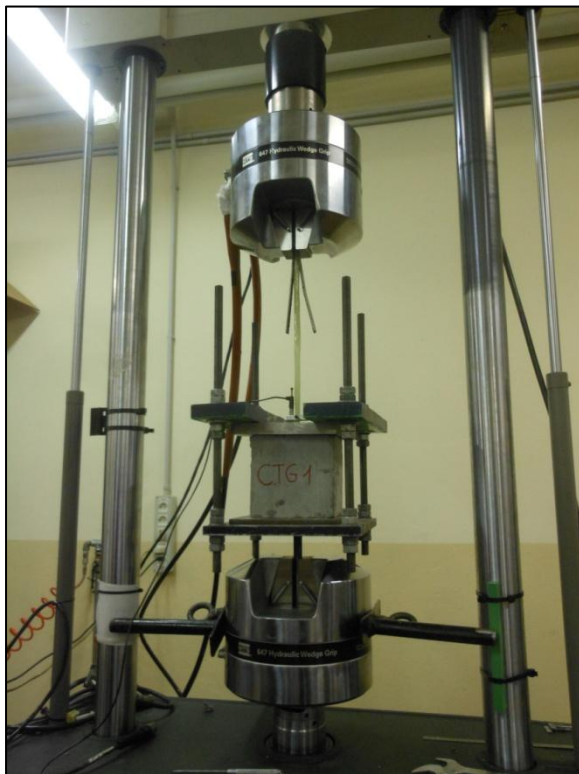
Figure 7.16 e 7.17 – Attrezzatura di prova: macchina MTS con particolare dell'ancoraggio del trasduttore per l'acquisizione degli spostamenti
