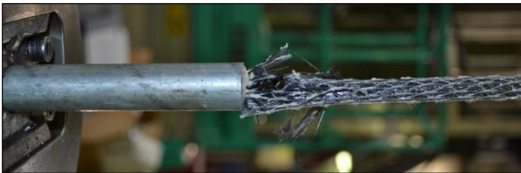
Figura 4.33 – Particolare di rottura del connettore in CFRP impregnato all'afferraggio
