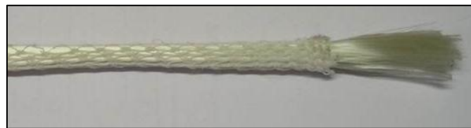
Figura 5.7 - Corda in fibra di vetro per la connessione strutturale e l'ancoraggio di tessuti CFRP
