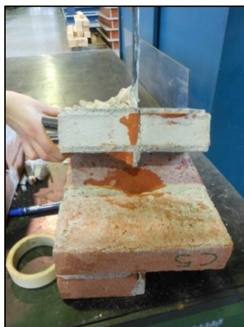
Figura 6.7 – Particolare di rottura del provino MC5. Si può notare la lunghezza d'ancoraggio ridotta rispetto agli altri provini
