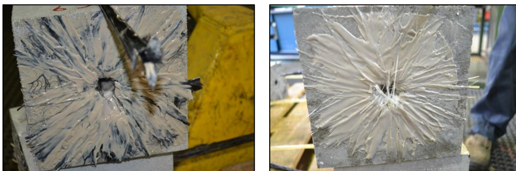
Figure 6.32 e 6.33 – Confronto tra le modalità di rottura dei fiocchi in CFRP e GFRP per lo stesso campione in calcestruzzo
