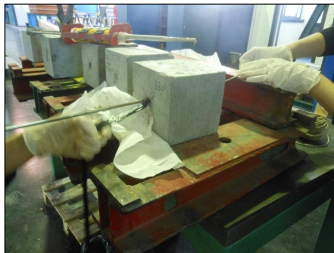
Figura 7.12 – Inserimento del connettore impregnato nel foro, dopo l'apposizione della resina inghisante Sika® AnchorFix® -3 +
