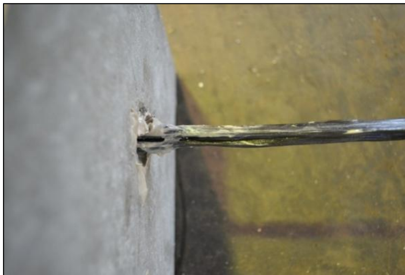
Figura 6.3 – Campione C2: particolare rottura per sfilamento del connettore
