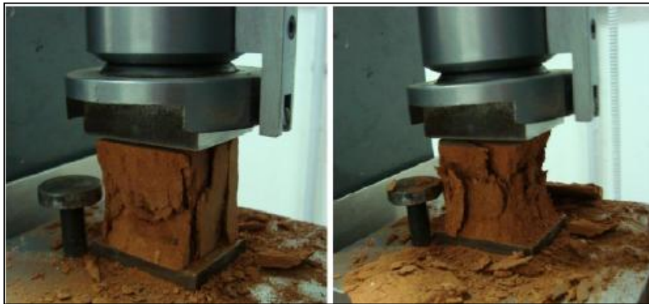
Figure 4.1 e 4.2 – Immagine della rottura riscontrata durante l'esecuzione delle prove di compressione
