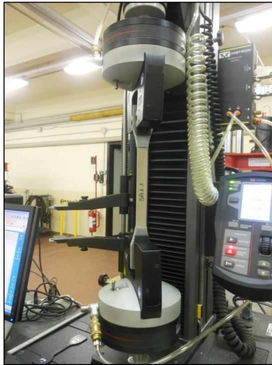
Figura 4.18 – Immagine dei campioni Sika® Anchorfix®-3+ sottoposti a prova di trazione monoassiale con la macchina INSTRON
