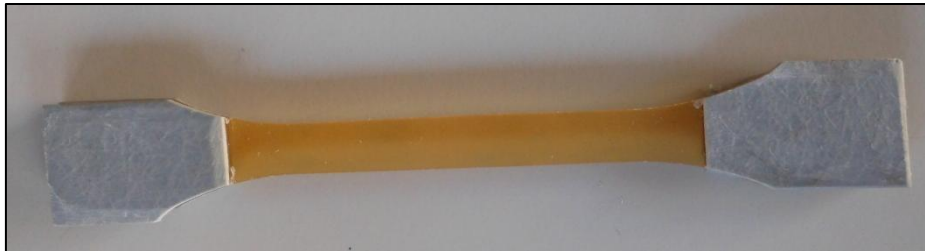
Figura 4.14 – Immagine dei campioni realizzati con resina Sikadur®-52 Injection
