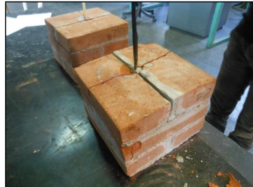
Figura 6.21 – Rottura di tipo E del campione MC1. Crisi in corrispondenza del giunto di malta e rottura dei mattoni dell'ultimo corso da ambo i lati del connettore
