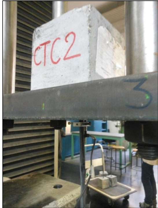
Figure 7.14 e 7.15 – Attrezzatura di prova (vista anteriore e posteriore): macchina Schenck
