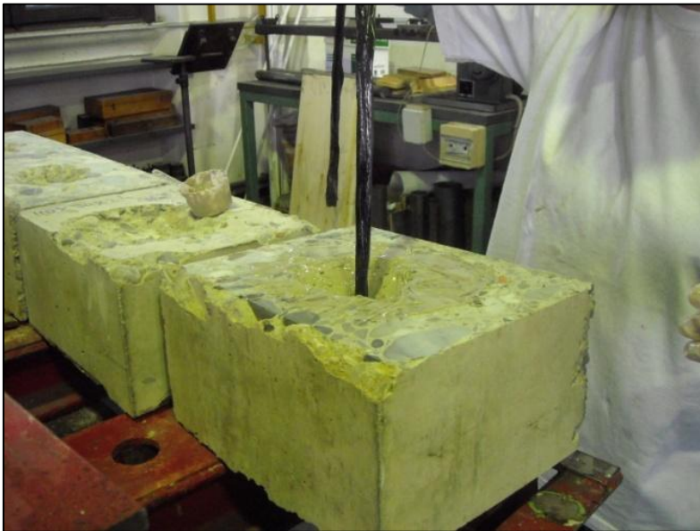
Figura 5.10 – Inserimento barra in fibra di carbonio impregnata nel foro del provino precedentemente cosparso all'estremità, per tutta la lunghezza del fiocco, con la resina inghisante Sika® AnchorFix® -3 +
