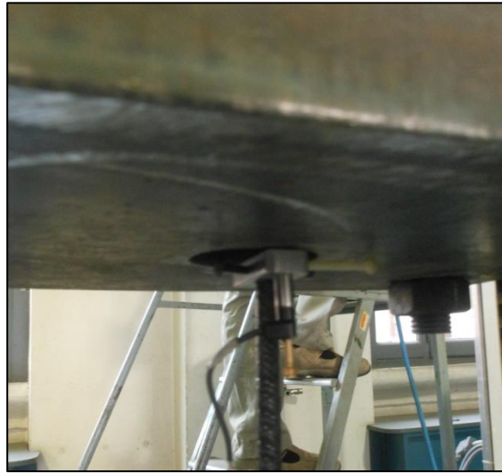
Figure 7.36 e 7.37 – Immagini del trasduttore e del suo posizionamento sulla barra in acciaio
