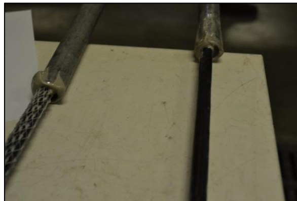
Figura 4.24 – Immagine del particolare di scorrimento tra barra e afferraggio
