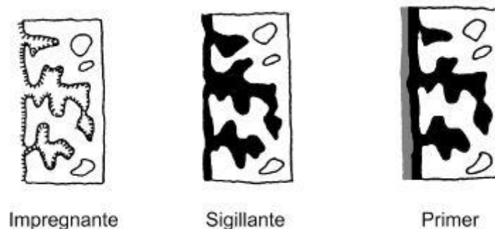
Figura 3.12 – Esempio di applicazione di impregnante sigillante e primer
