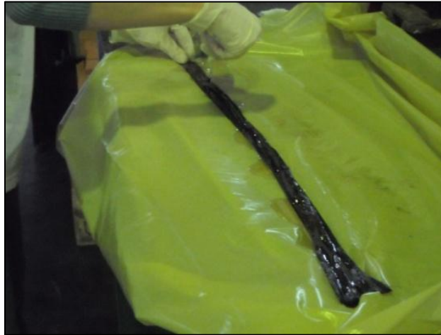
Figura 5.8 – Preparazione barra in fibra di carbonio mediante impregnazione delle fibre con resina epossidica
