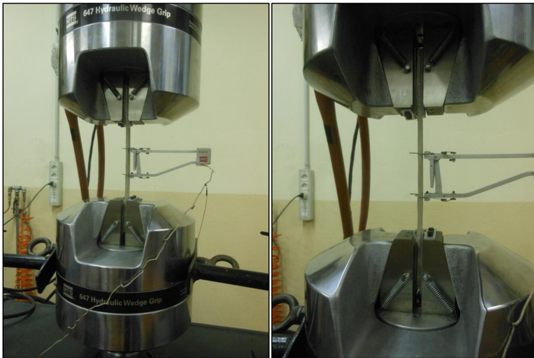
Figure 4.21 e 4.22 – Immagine dei campioni Sika® Anchorfix®-3+ sottoposti a prova di trazione monoassiale con la macchina MTS
