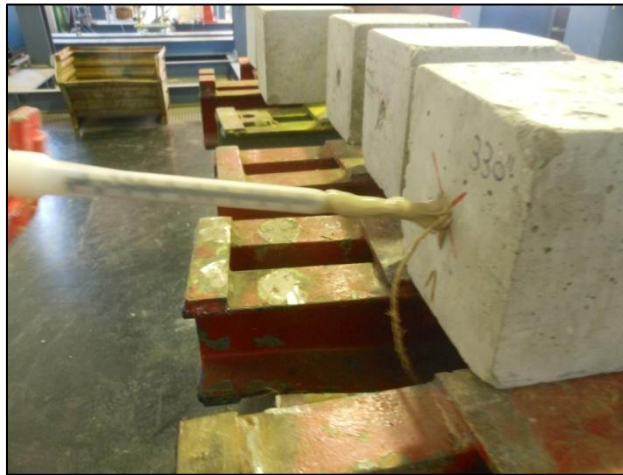
Figura 7.31 – Riempimento del foro con la resina inghisante Sika® Anchorfix® .3 +
