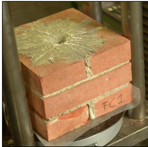
Figura 5.14 – Provino in mattoni sabbati e malta Sika® Muratura a 3 corsi di mattoni
