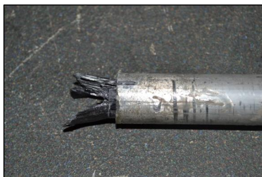
Figura 6.23 e 6.24 – Particolare tondino in acciaio (sx) e in PVC (dx) per evitare il contatto connettore - calcestruzzo e connettore - muratura
