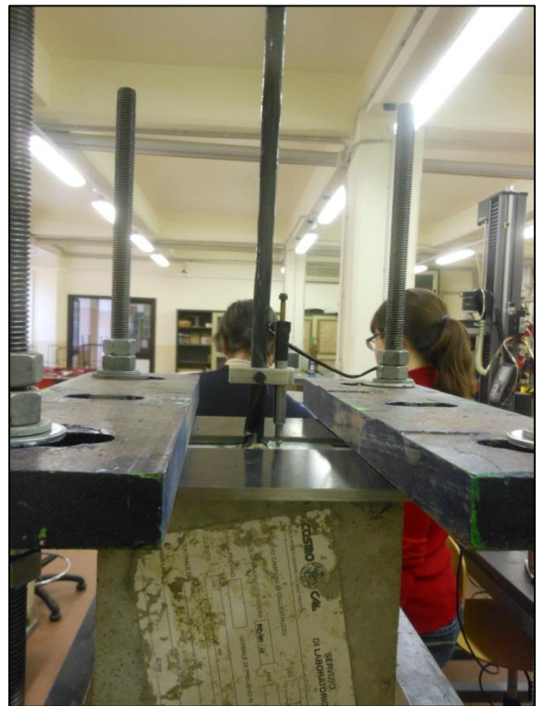
Figure 7.16 e 7.17 – Attrezzatura di prova: macchina MTS con particolare dell'ancoraggio del trasduttore per l'acquisizione degli spostamenti
