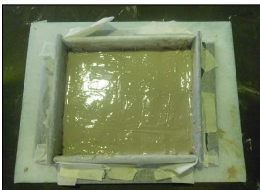
Figure 4.10 e 4.11 – Resina Sika® Anchorfix®-3+ nello stampo, data la poca fluidità della resina è stato necessario stendere la resina a mano per ottenere uno spessore del panetto il più regolare possibile
