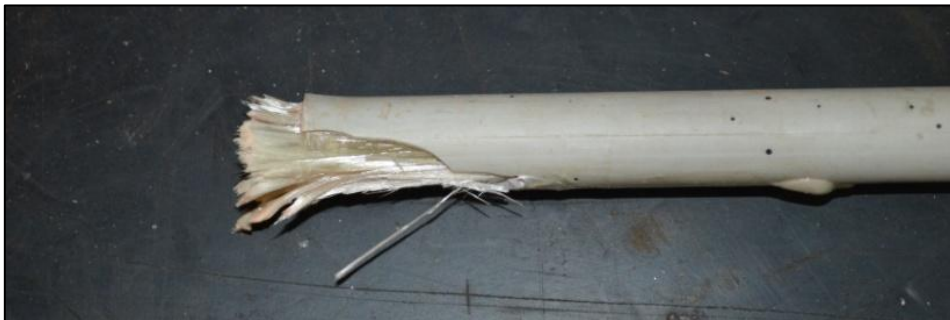
Figura 5.16 – Particolare di protezione della barra in GFRP adottato durante le prove condotte sui fiocchi
