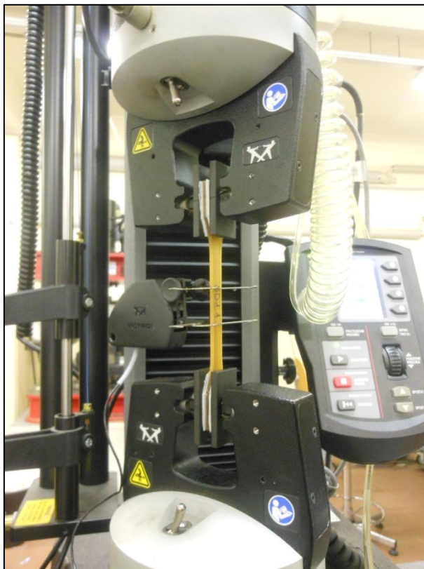
Figure 4.16 e 4.17 – Immagine dei campioni Sikadur®-52 Injection sottoposti a prova di trazione monoassiale con la macchina INSTRON
