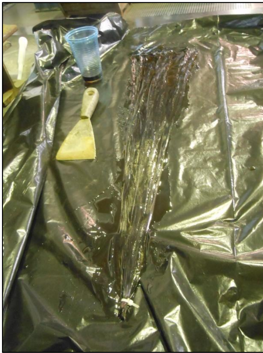
Figure 7.10 e 7.11 – Impregnazione della corda in fibra di carbonio con resina bicomponente
