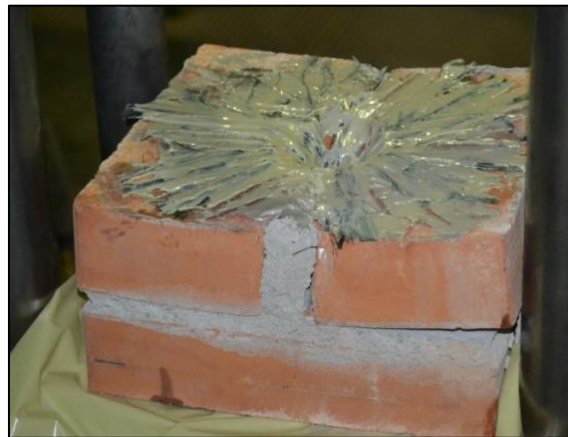
Figura 5.15 – Provino in mattoni standard e malta Sika Monotop® - 722 Mur a 2 corsi di mattoni
