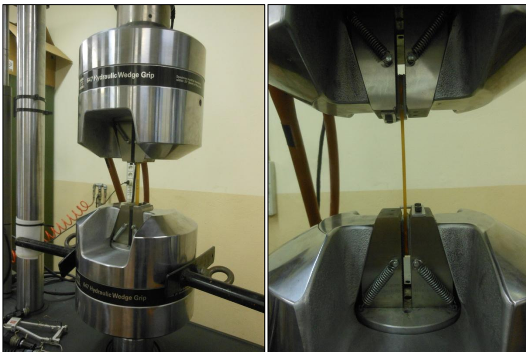
Figure 4.19 e 4.20 – Immagine dei campioni Sikadur®-52 Injection sottoposti a prova di trazione monoassiale con la macchina MTS
