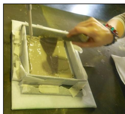
Figure 4.10 e 4.11 – Resina Sika® Anchorfix®-3+ nello stampo, data la poca fluidità della resina è stato necessario stendere la resina a mano per ottenere uno spessore del panetto il più regolare possibile
