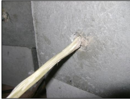
Figura 6.4 – Rottura del campione G2 all'innesto del blocco in cls
