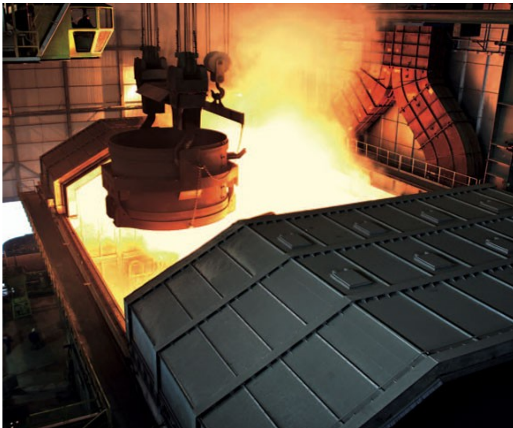
Figura 1.10 – Immagine di una Elephant-House aperta per consentire l'operazione di carica del forno
