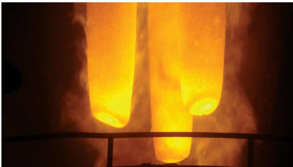
Figura 1.5 - Esempio di elettrodi ben consumati
