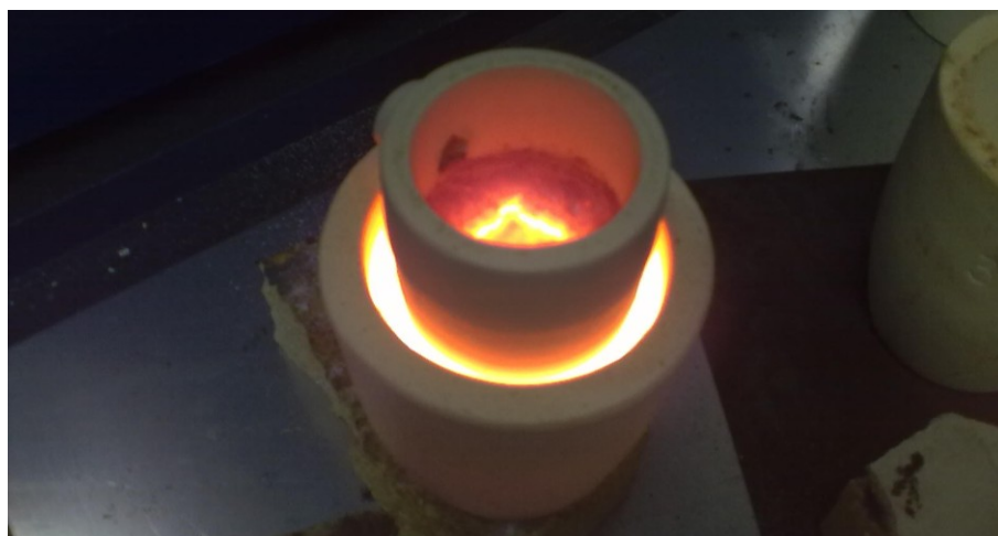
Figura 3.2 - Crogiolo super-alluminoso capace di contenere campioni pari a oltre 100g di fumo tal quale e le relative aggiunte di silice
