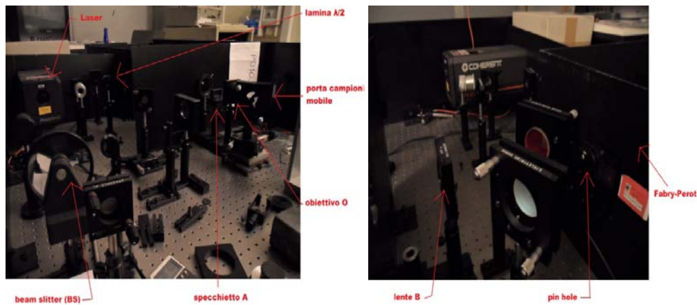
Figura 4.2 Alcuni particolari dell'apparato sperimentale
