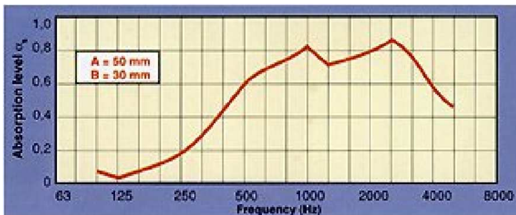
Figura 6.77. Grafico dell'andamento del coefficiente di assorbimento del materiale in funzione della frequenza
