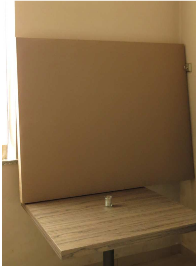
Figura 8.102. Prototipo di un pannello fonoassorbente costruito utilizzando Acustideco®
