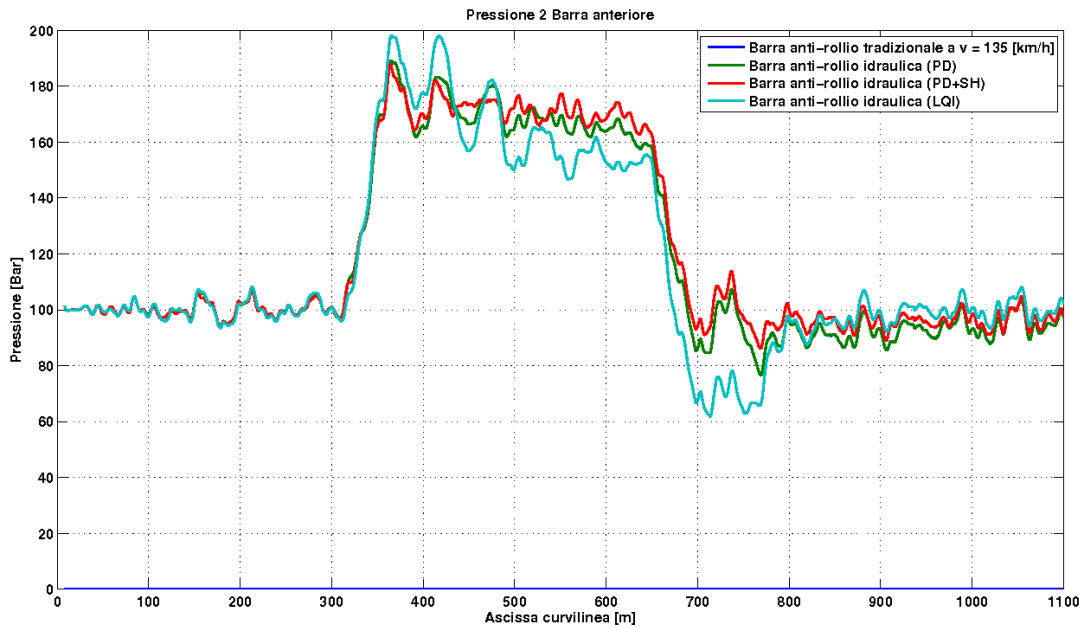
Figura 6.16: Confronto della pressione nel circuito 2 della barra anti-rollo in curva tradizionale
