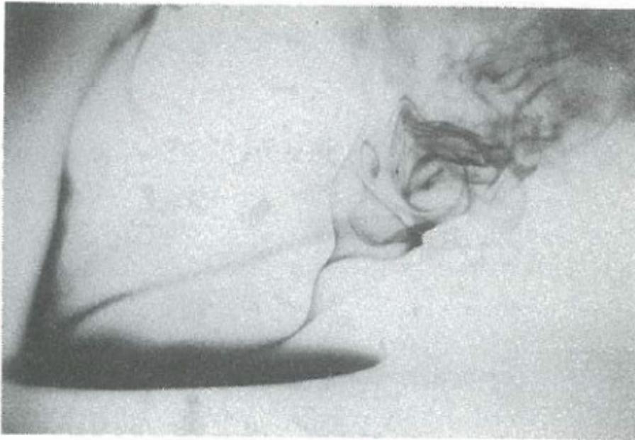
Figura 15 – Particolare che evidenzia il “ vortex breakdown ” per R = 4 e Re = 1600 [12]
