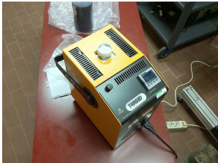
Figura 30 - Forno utilizzato per la calibrazione
