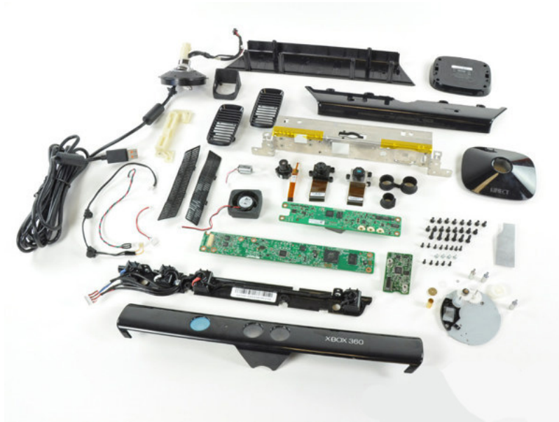
Figura 3.6: Disassemblaggio del Kinect
