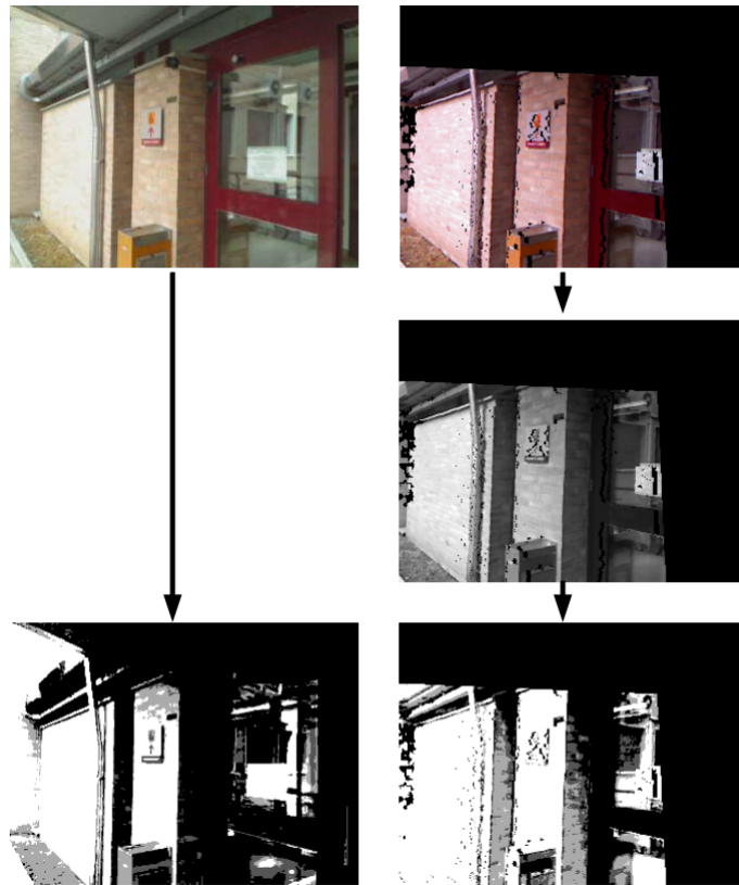
Figura 4.20: Fasi della procedura di equalizzazione
