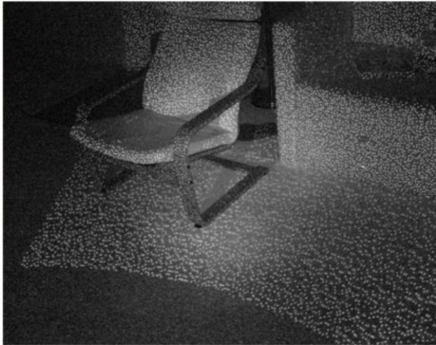
Figura 3.12: Pattern infrarosso emesso dal Kinect
