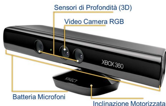
Figura 3.2: Posizionamento dei componenti sul dispositivo
