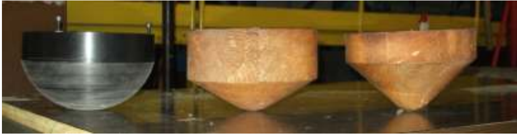
Fig. 4.3: Forme di galleggiante testate
