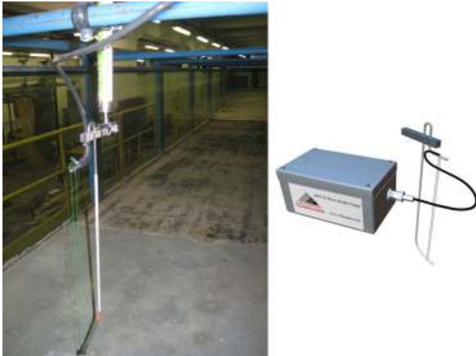
Fig. 3.3: Particolare di una sonda capacitiva utilizzata per la misura delle altezze d'onda
