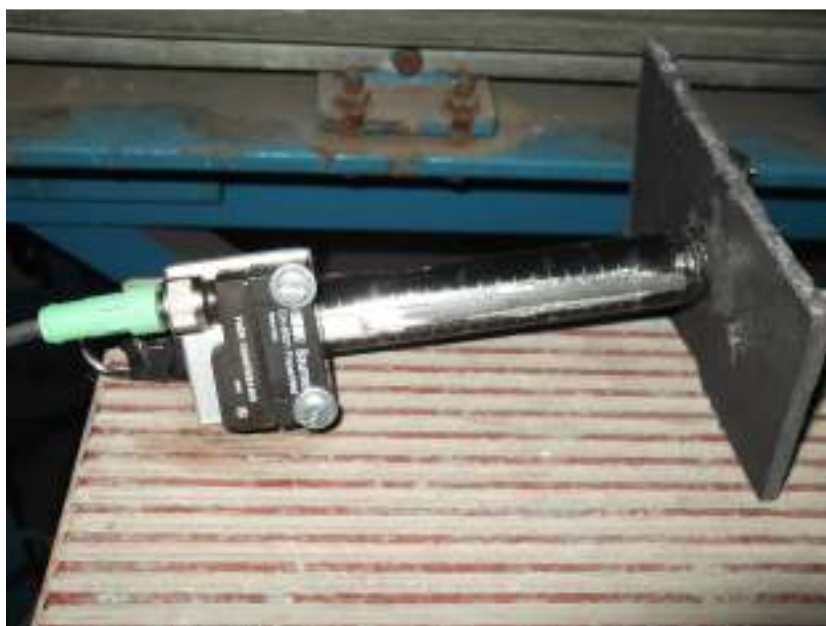
Fig. 3.11: Dinamometro e fotocellula per le misure sulla pala
