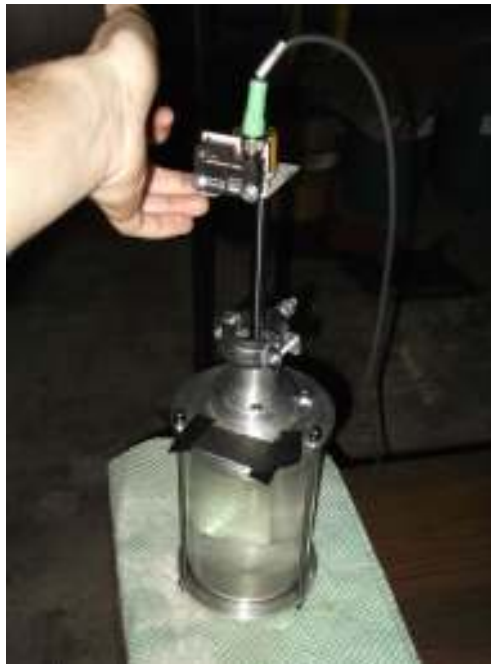
Fig. 3.9: Particolare: lo smorzatore
