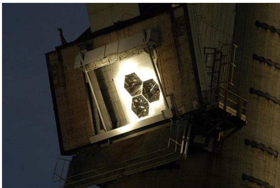
Figura 14: Immagine dell'impianto di test SOLGATE a CESA 1 [17]
