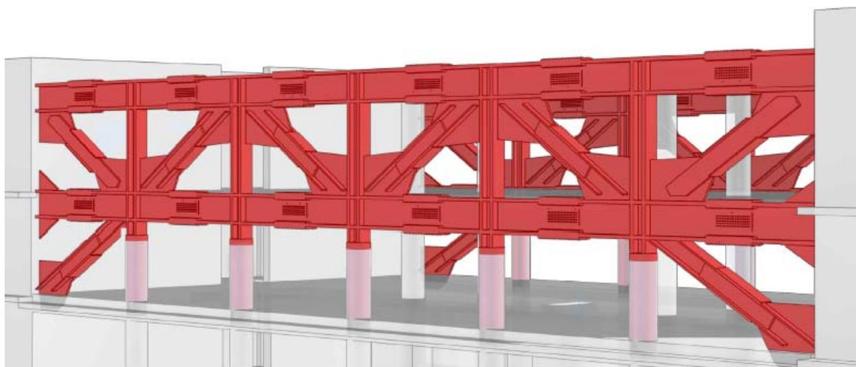
**Figura 7.3 - Belt truss di copertura in acciaio**
