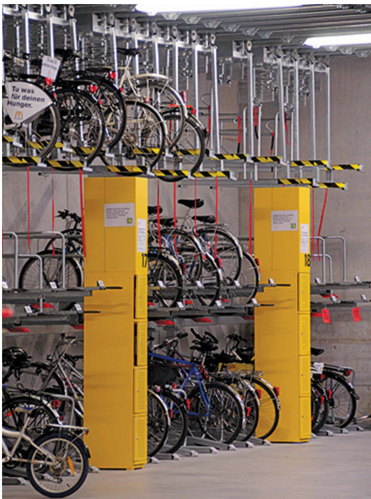
sistema di posteggio su 3 livelli della ciclostazione di Berna
