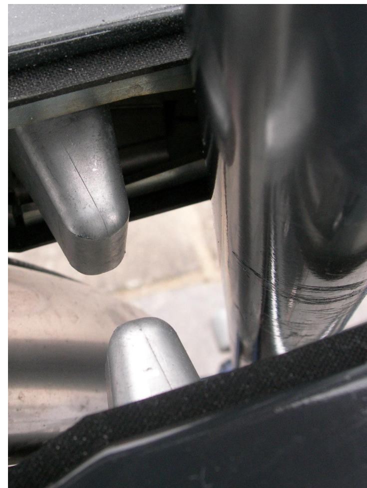
Lock'N'Go: particolare cancelletto che chiude il tubo verticale del telaio
