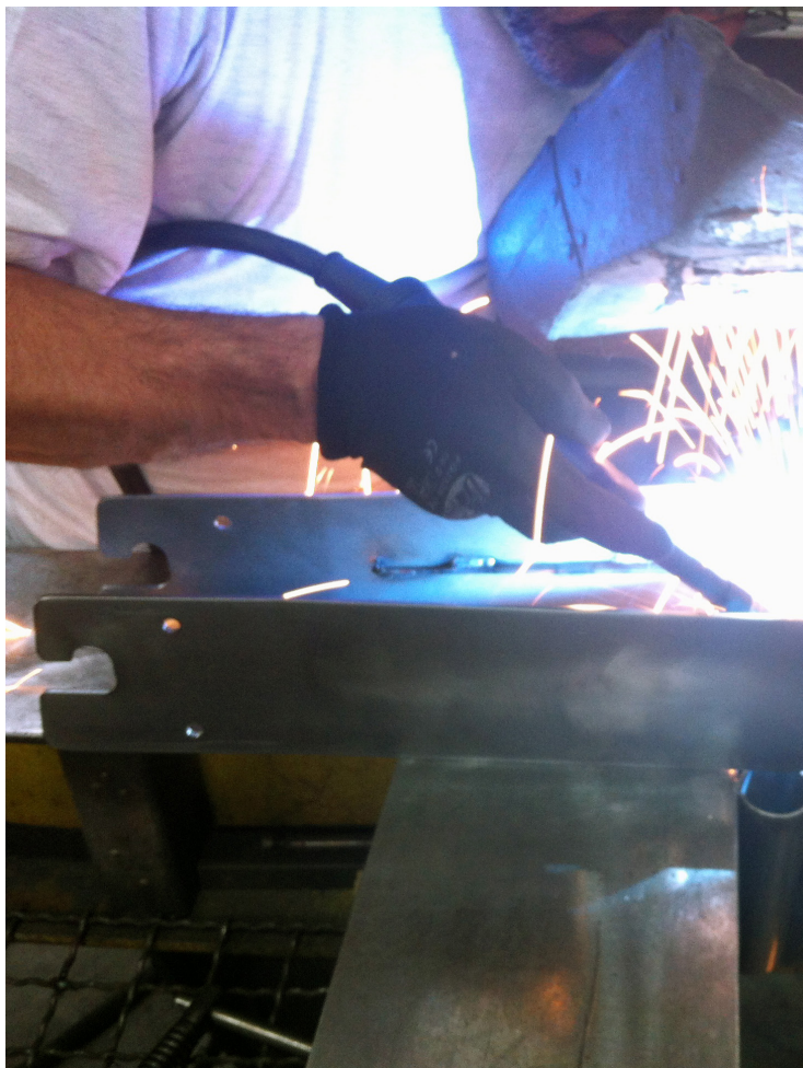
prototipo: saldatura del fazzoletto di rinforzo
