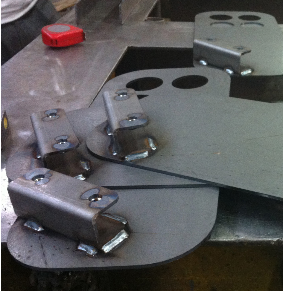
prototipo> saldatura a filo dei supporti ad U
