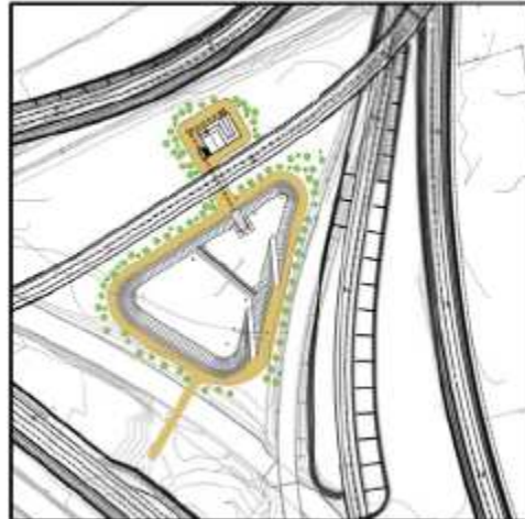
Figura 3.22 - Confronto vasche tra Progetto Esecutivo e proposta di variante
