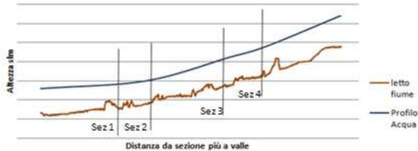
Figura 116: Esempio del profilo di piena in corrispondenza delle sezioni considerate
