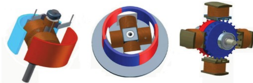
Figura 11: motori in corrente continua (DC). Da sinistra a destra: motore a spazzole, motore brushless, motore passo-passo.
