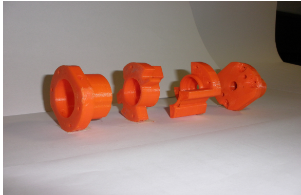
Figura 7: gruppi ottici della telecamera realizzati con una stampante 3D.
