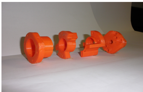
Figura 64: gruppi ottici della telecamera realizzati con una stampante 3D.
