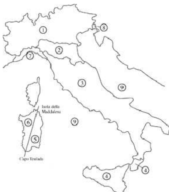
Fig. 6.6 - Zonizzazione per carico del vento.
