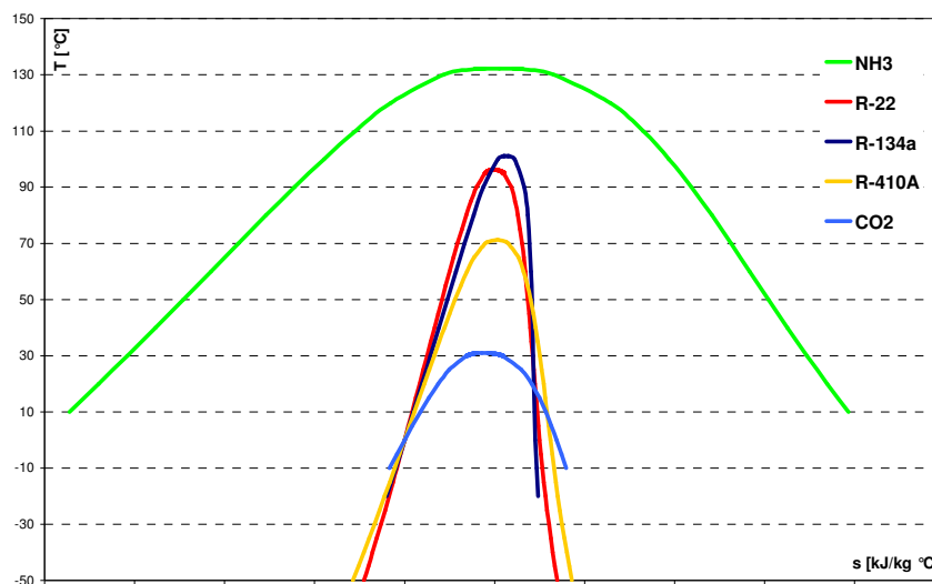
Figura 1.2. Grafico T-s di vari fluidi refrigeranti.
