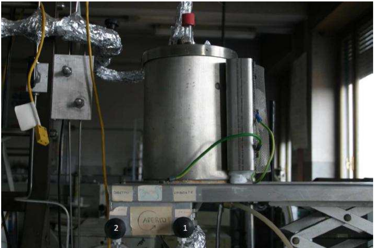
Figura 2.14 forno elettrico, valvola raffreddamento T < 500^{\circ}\text{C} (1) e T < 200^{\circ}\text{C} (2).
