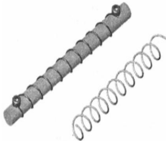
Figura 22: imposizione forma molla elicoidale a un filo Ni-Ti
