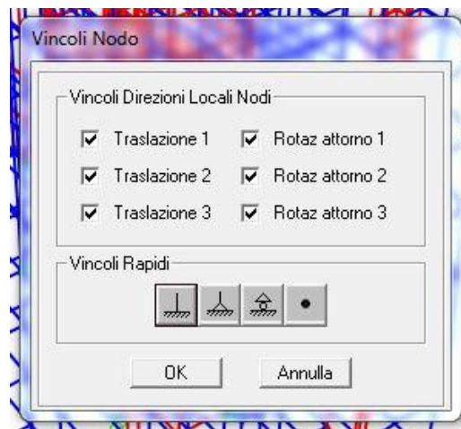
Figura 21 Modalità di definizione dei vincoli in SAP2000
