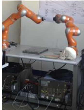
Figura 1.6 : Setup di laboratorio: KUKA LWR4+ con relativi controllori e PC real-time
