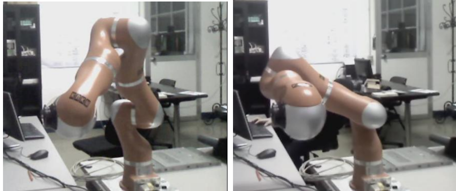
Figura 6.44 : Moti interni del robot dati da task secondario per massimizzazione della controllabilità lungo l'asse y
