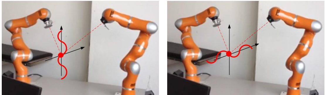
Figura 2.11 : Esempio di strategia Task Space Oriented in una applicazione di compensazione del moto periodico di un target.
