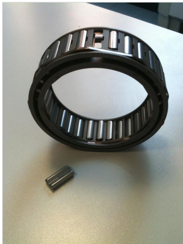
Figura 2.2 Ruota libera BorgWarner con dettaglio sprag
