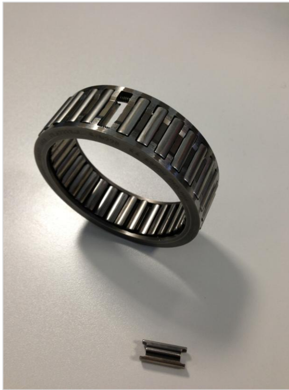
Figura 2.3 Ruota libera Formsprag con dettaglio sprag dotato di “aletta”
