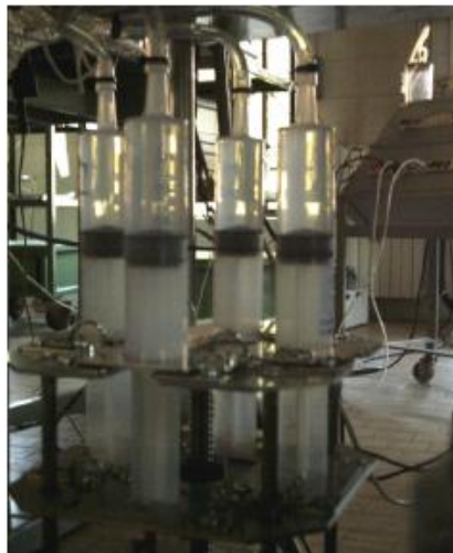
Figura 2.8 Particolare del sistema pompante dotato di pistoni rigidi [Cercenelli (2002), Bagnoli (2005)].
