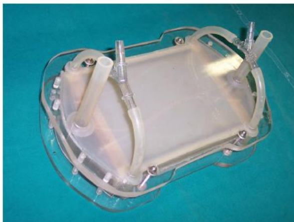
Figura 2.10 - Pro-Li-Ve; le uscite e gli ingressi del lato gas sono collegate con raccordi ad "Y"; i due tubi in silicone da 3/8" sono ingresso e uscita del lato sangue [Fiore et al., 2000].
