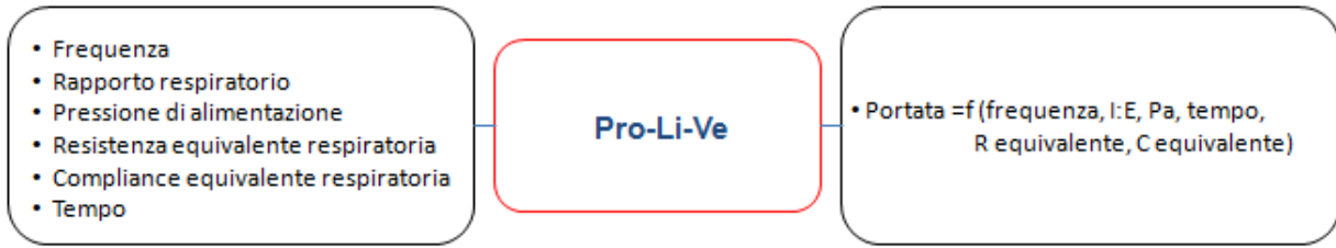
Figura 4.1 - Schema a blocchi dei parametri in ingresso e uscita dal sistema pompante; il blocco di sinistra rappresenta l'insieme dei parametri in ingresso al sistema, mentre il blocco di destra indica l'uscita del sistema, ovvero la portata come funzione di questi parametri.
