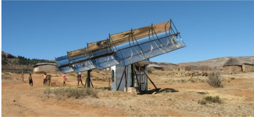
Figura 1.3: ORC presso un impianto solare di tipo specchio concavo-ricevitore (1 KW_{el} ), Lesotho, Africa (fonte: www.solarturbinegroup.org ), esempio di solare a bassa concentrazione.
