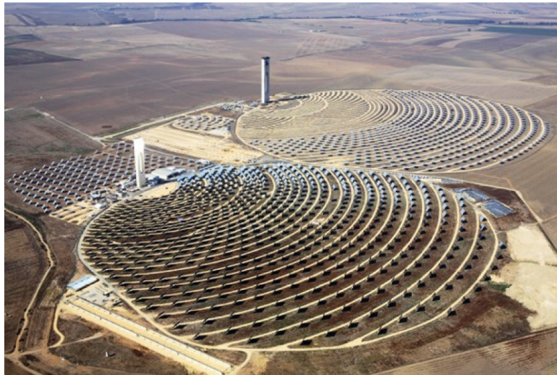
Figura 1.2: Impianti Abengoa S.p.A. Solar 1 (10 MW el ) e Solar 2 (20 MW el ), tipologia ricevitore-torre , Spagna, esempio di solare ad alta concentrazione (fonte: www.abengoa.es ).
