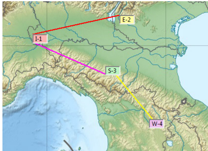
Figura 4.6: Un esempio di collegamento tra nodi: in rosso il link è di tipo Ethernet ed è instaurato tra un router IP (I-1) e uno switch Ethernet (E-2), in viola è di tipo SDH/OTN fra il router IP e un apparato SDH/OTN (S-3), in giallo il link è di tipo fibra e connette l'apparato SDH/OTN con uno WDM (W-4).
