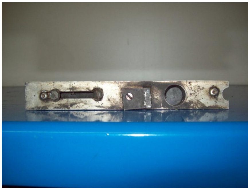
Figura 5.10 Pressaprovino con provino vista esterna
