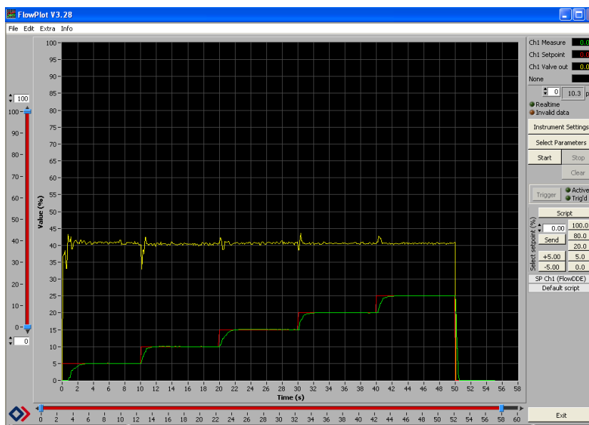
Figura 5.9 Esempio scalino multiplo variazione portata di ossidante
