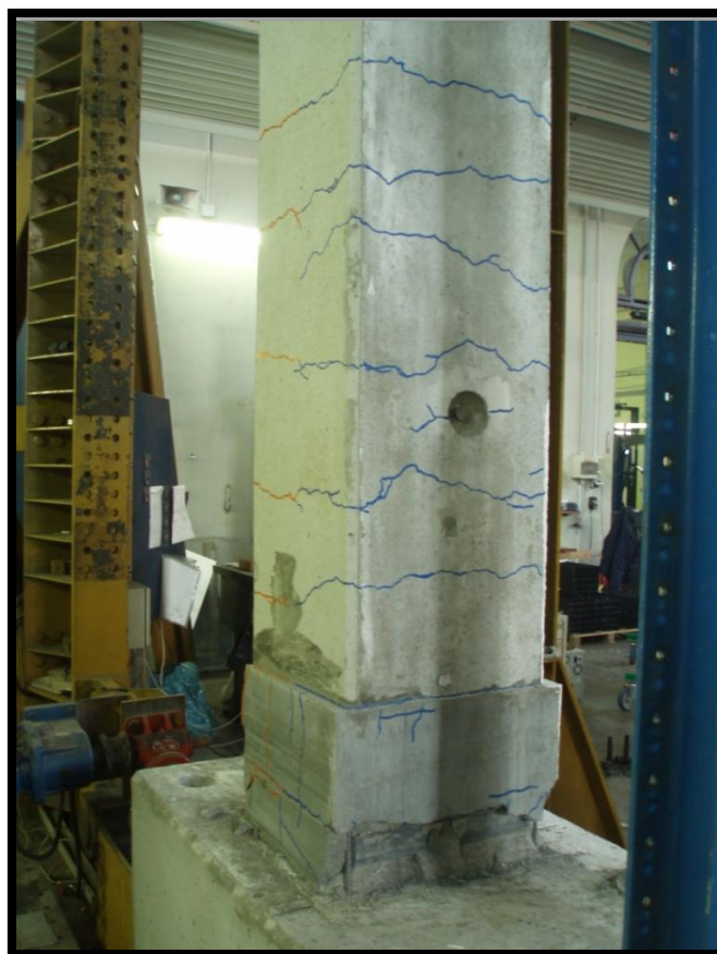
Figura 2.44 Distribuzione delle fessure al termine della prova
