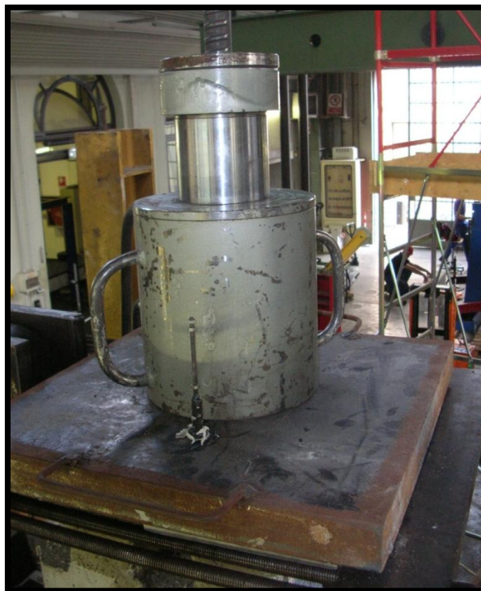
Figura 2.8 Applicazione del carico verticale tramite una barra Dywidag
