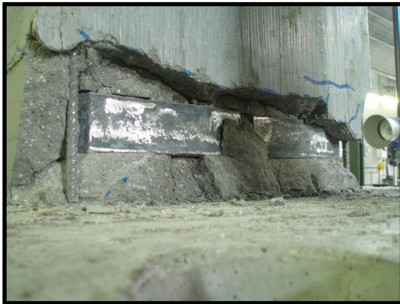
Figura 2.48 Connessione al termine della prova
