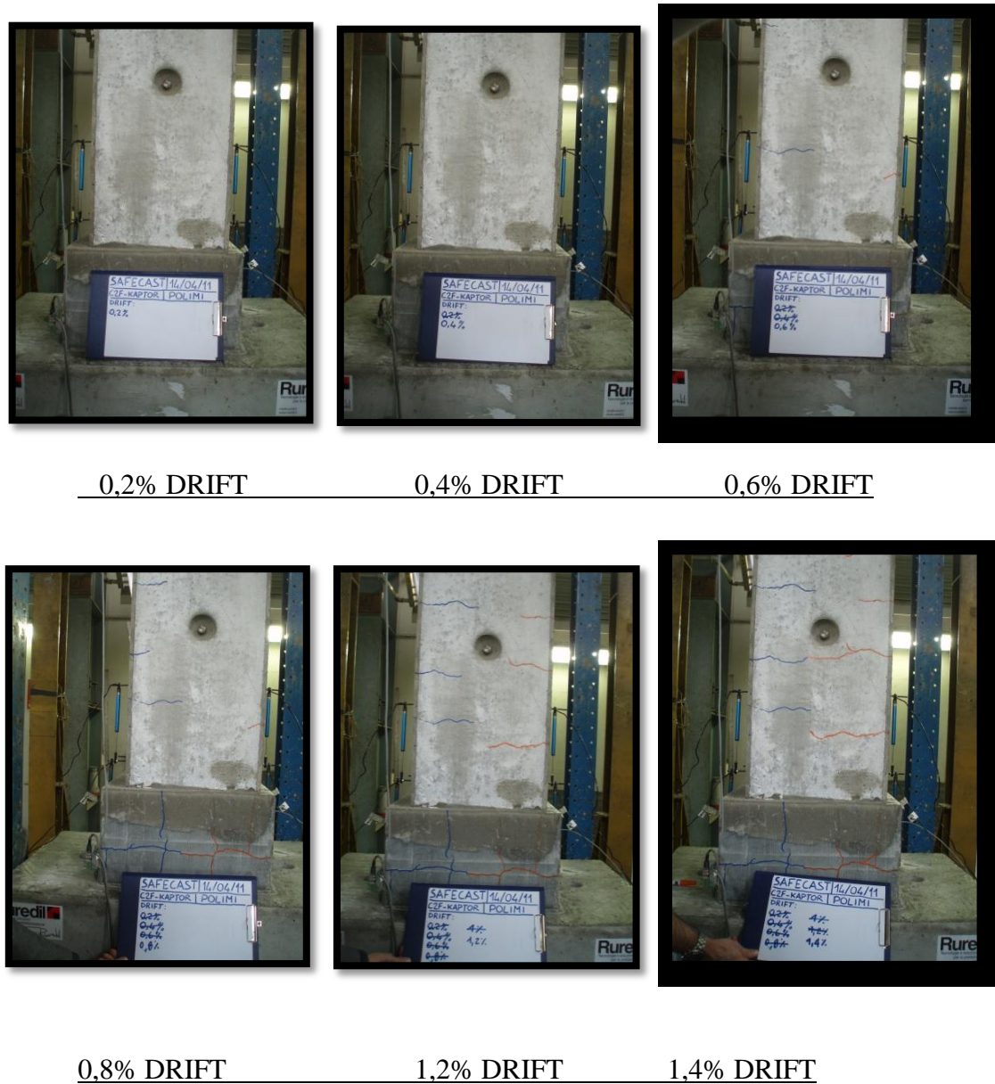
Figura 2.49 Sviluppo delle fessure fino all'1,4% di drift durante la prova
