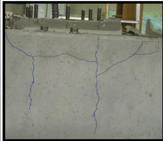
Figura 2.32 Fessure all'interfaccia tra pilastro e fondazione una volta tolto il pilastro e fessura in fondazione
