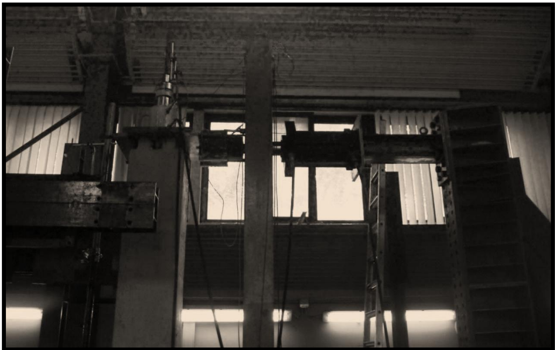
Figura 2.4 Schematizzazione del setup di prova. In evidenza la fondazione fissata alla trave in acciaio e il martinetto orizzontale
