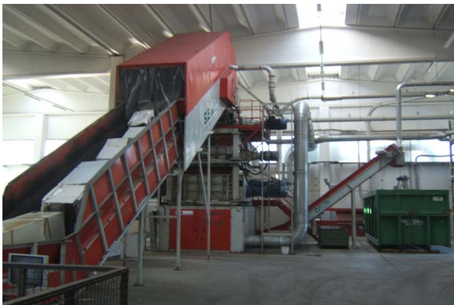
Figura 3.6: Impianto di triturazione e separazione dei materiali
