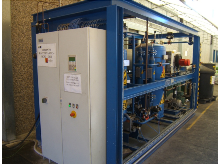
Figura 3.4: Macchina per la messa in sicurezza dei frigoriferi
