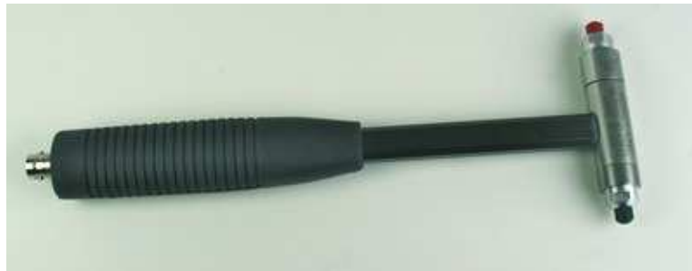
Figura 1.22: Martello dinamometrico PCB Piezoelectric 086C03
