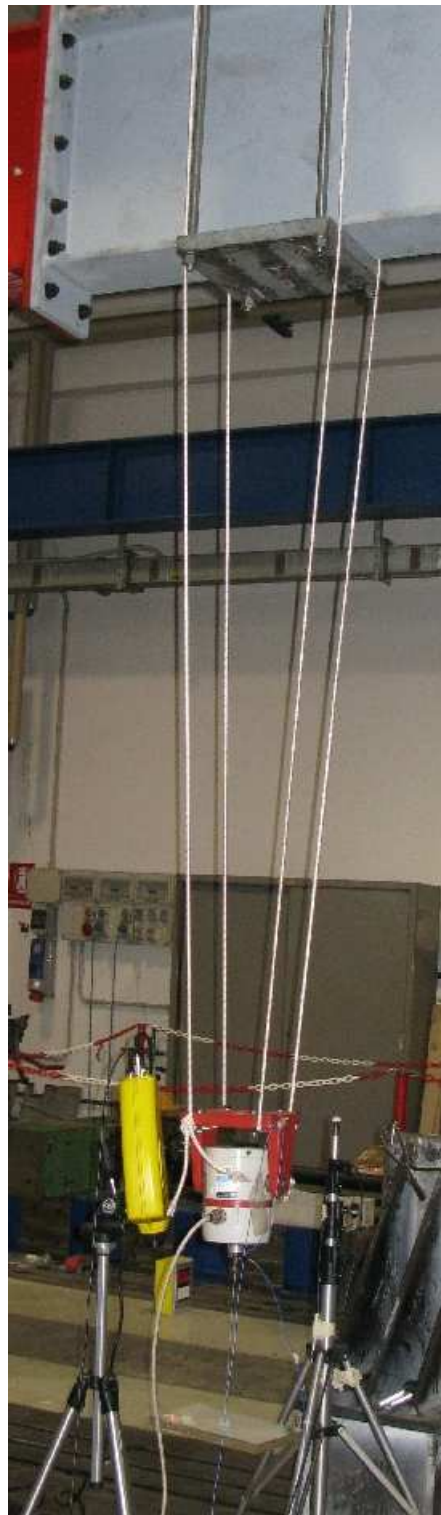
Figura 1.18: Setup di misura utilizzato. Si noti come lo shaker viene vincolato al portale tramite le funi.
