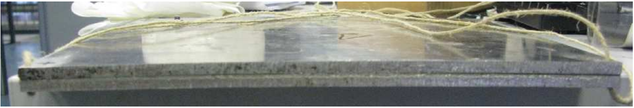
Figura 3.10: Vista in sezione delle piastre in alluminio incollate con araldite
