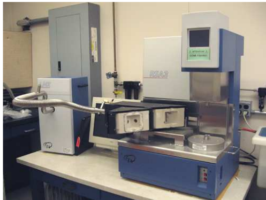
Figura 2.21: Macchina DMA RSA3 della TA instruments usata per effettuare le prove
