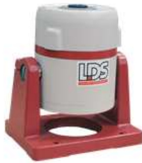
Figura 1.15: Eccitatore elettrodinamico utilizzato per il forzamento
