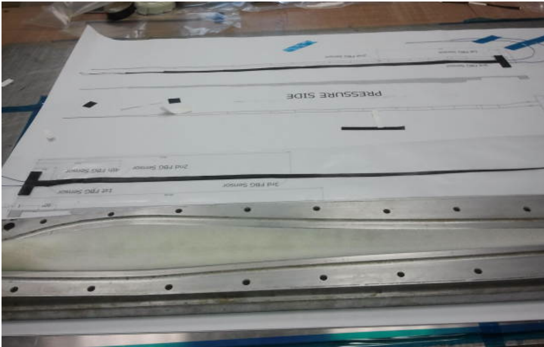
Figura 4.9 Processo di laminazione
