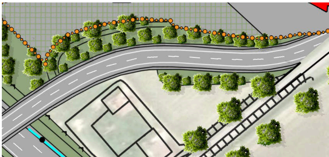
Figura 93: Estratto dalla Tavola 13: Trattamento a verde delle scarpate del cavalcavia di Via Ravagnana presso l'area di sosta di progetto "Valli Grandi" (Elaborazione dell'autore)
