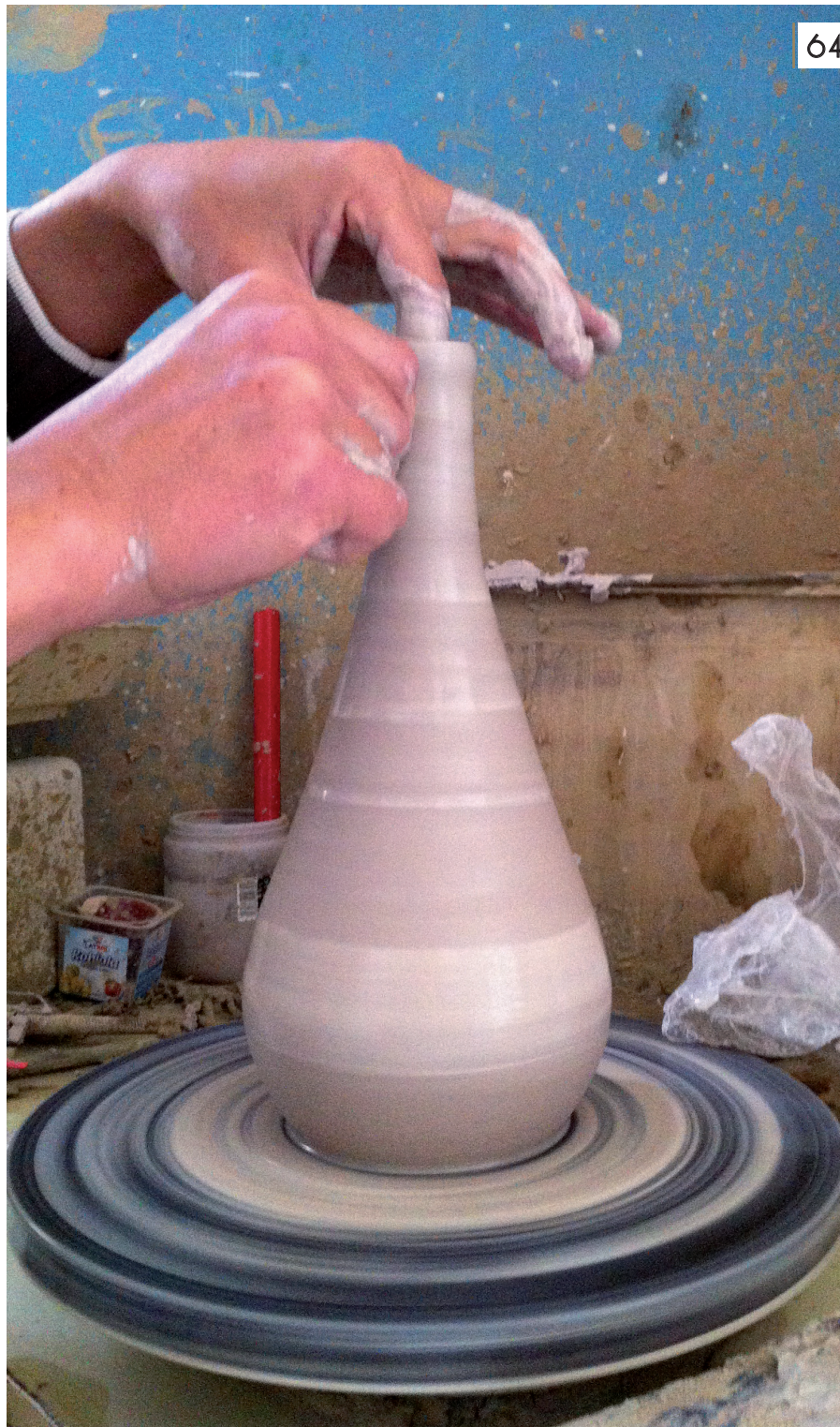
64 . Tornitura manuale di un blocco di argilla bianca, futuro vaso Fireworked.
