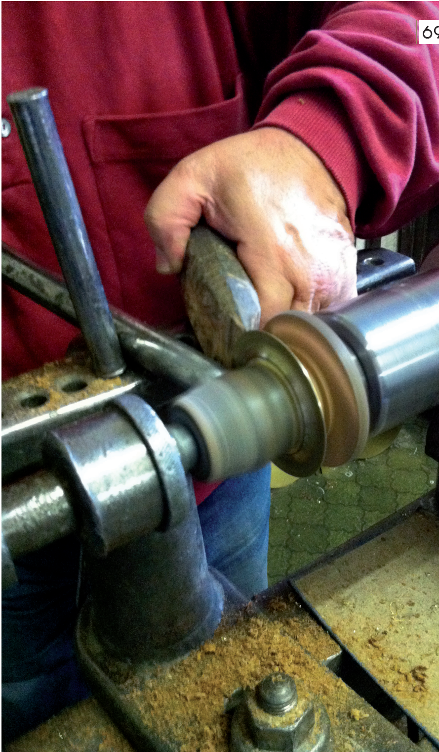
69 . Tornitura e curvatura in lastra di un disco di ottone per Parvenu.
