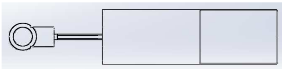
Figura 6.12. Vite che permette la regolazione dell'attacco
