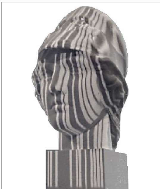
Figura 5.4 - Tecnica di acquisizione a proiezione di pattern
