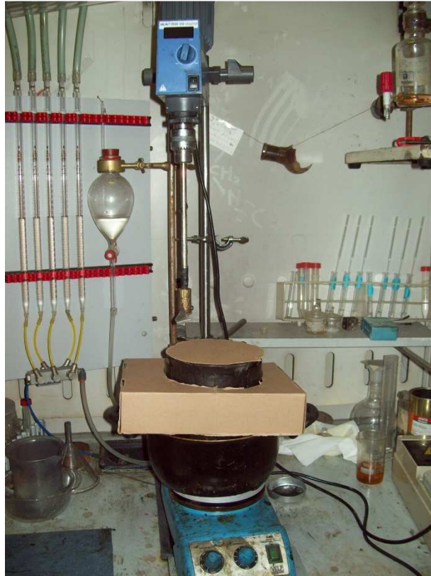
Figura 28 : Mixer automatico con combustibile a bagno nell'olio e posto sul riscaldatore elettrico.
