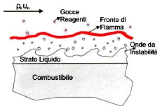
Figura 5 : Meccanismo di instabilizzazione di combustibili basso-fondenti.
