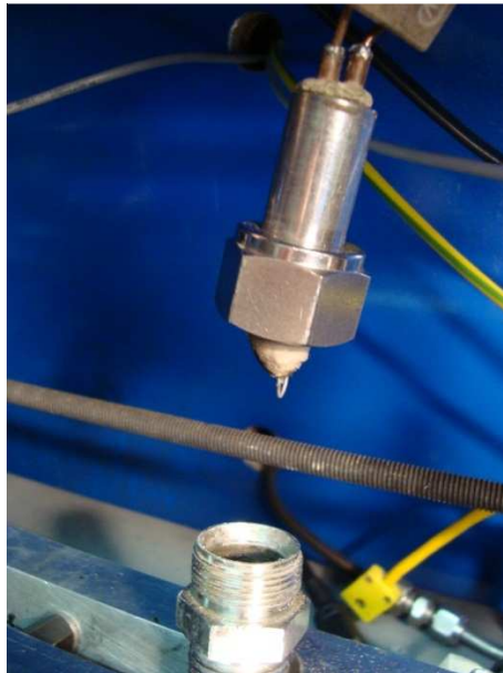
Figura 15 : Accenditore mentre viene inserito nel suo alloggiamento nel quale si trova il "Candy propellant".
