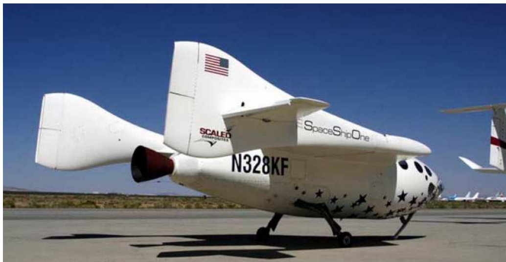
Figura 2 : Il lanciatore suborbitale SpaceShipOne, costruito da Scaled Composites con materiali compositi, utilizza un motore a razzo ibrido costruito da SpaceDev. Primo volo di un veicolo spaziale commerciale alla quota massima di 100.124 km in data 21 giugno 2004 (Rif.: De Luca [1]).
