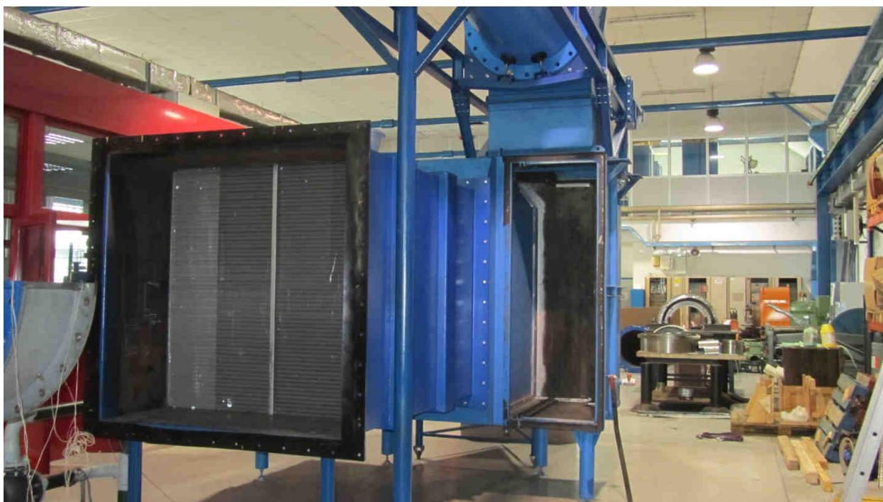
Figura 1.3: Camera di stanca e scambiatore di calore.
