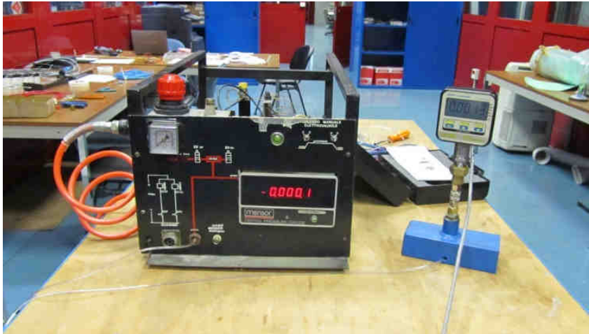
Figura 2.12: Sistema per la taratura dei trasduttori di pressione.
