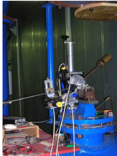
Figura 4.3: Particolari della sonda di pressione durante la prova di taratura.
